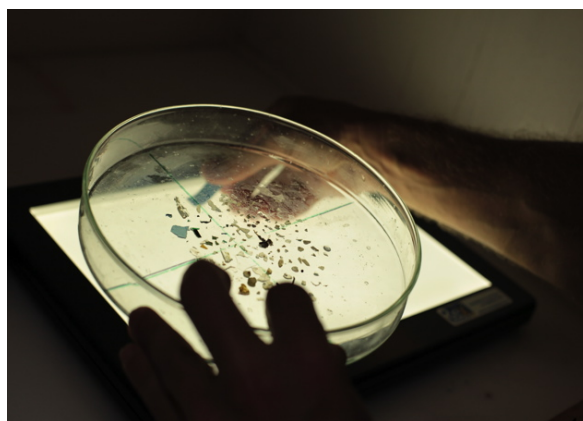
La boîte de Petri est placée sur une plaque lumineuse pour faire l'inventaire des microplastiques. Crédit : N.Pansiot
